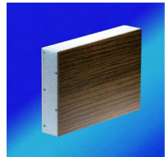
Ausführung FB 4 mit beidseitiger Aluminiumdeckschicht 1,5 mm, Ral 9016 Kern: extr. Polystyrolschaum 21 mm, WLG35, U-Wert 1,299, Plattenstärke 24 mm
